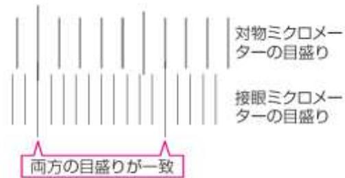
④ 両方の目盛りが一致している2か所をさがし、その間の接眼ミクロメーターの目盛り数と対物ミクロメーターの目盛り数を読む。
